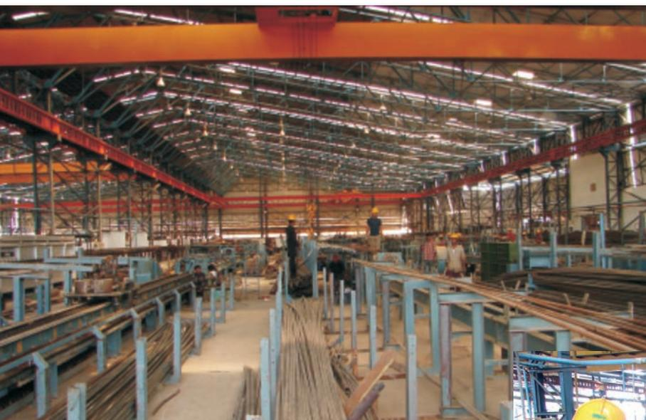
Hohlprofilen hergestellt, die entweder im eigenen Haus produziert oder von zugelassenen Lieferanten gekauft werden. Nach dem Pilgern und Kaltziehen werden die Rohre je nach Bedarf gegläht, gerichtet und gebeizt und dann getestet, markiert und verpackt. Geschweißte Edelstahl-Rohre
