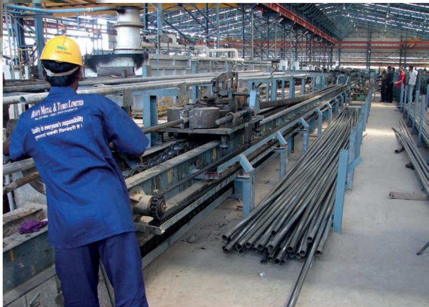
U-Bogenrohre sind bei Heavy Metal & Tubes in einer Reihe von Biegungstypen und -formen erhältlich und können in Längen bis 34 m geliefert werden, was in Indien relativ selten ist.
