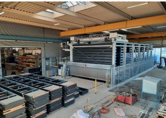
Das neue Kasto-Langgutlagersystem inklusive 112 Lagerkassetten hat zwei Stationen zum Ein- und Auslagern. Eine führt direkt neben den neuen Kasto-Bandsägeautomat. Die Aufträge können damit direkt aus dem Lagersystem an die Bandsäge weitergegeben werden.
